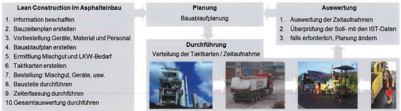
Bild 2. Lean Construction Methodik im Asphaltbau
